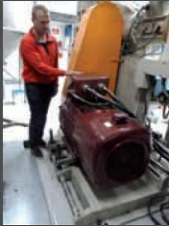
Stål & Plast ha aggiornato la linea di estrusione acquistando dei motori a magneti permanenti ad elevata efficienza.
