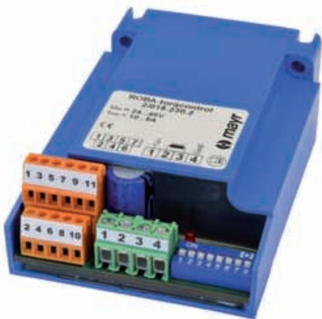
*Utilizzando il modulo ROBA®-torqcontrol viene eseguito il controllo finalizzato della coppia di frenatura. Il dispositivo può essere alimentato con una tensione di 24 V o 48 V c.c. ed è in grado di controllare freni con una corrente nominale nella bobina di 10 A o 5 A.*
